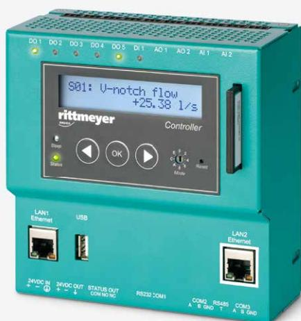
O Controlador recebe os dados dos sensores enviados pelo Módulo de Tempo de Trânsito Ultrassônico e calcula a vazão exata. Existem ainda diversas funções adicionais de cálculo possíveis no controlador.
