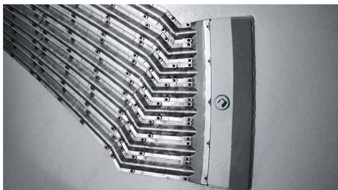
Uma tubulação exclusiva com proteção e de fácil instalação é utilizada para sensores instalados internamente em condutos. Como o próprio cabo do sensor já é à prova d'água, é necessária uma tubulação de proteção apenas para proteção mecânica.
